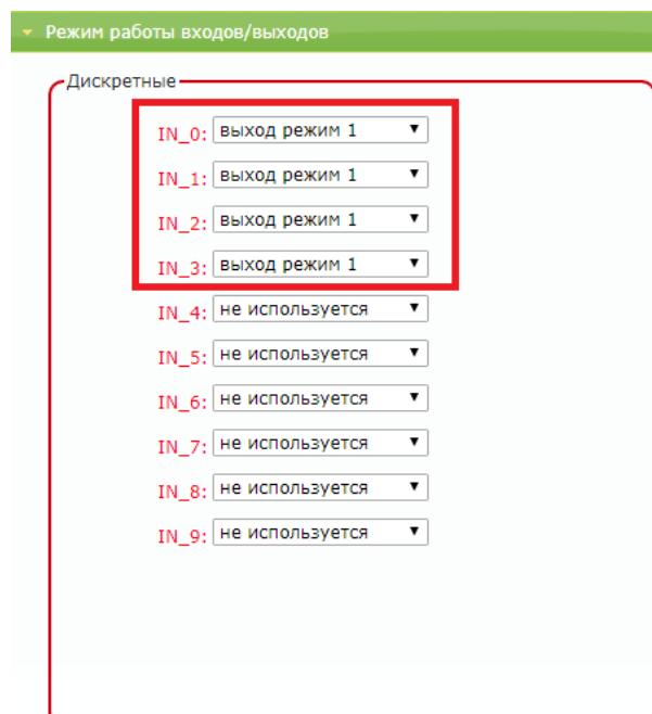
**Режим «выход режим 1»** – обычный режим работы выхода с сохранением состояния в энергонезависимую память и восстановлением после перезапуска устройства.
