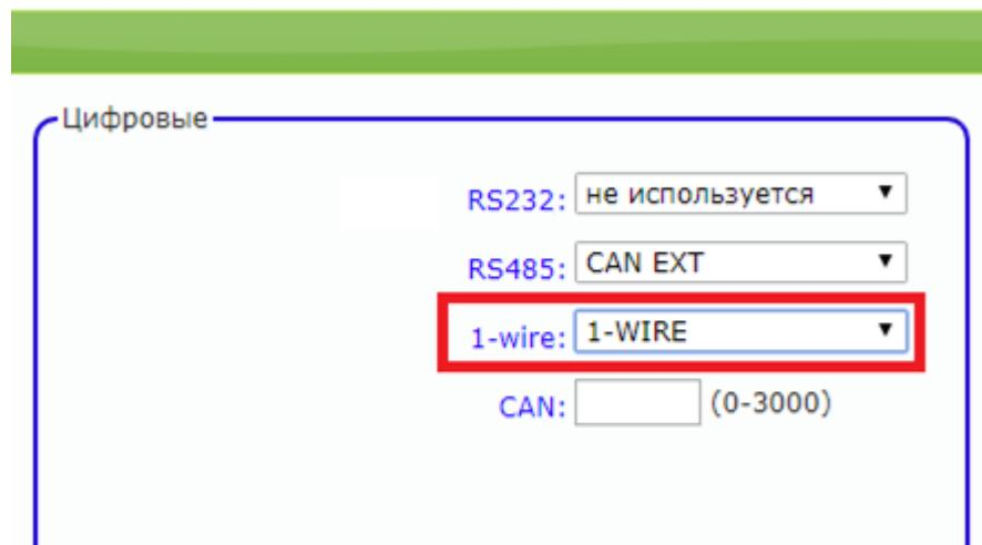
Для контроля температуры различных устройств или объектов используются датчики температуры, работающие по интерфейсу 1-wire (на однойшине данных может быть подключено до 8 датчиков одновременно).
