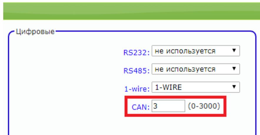
**ВНИМАНИЕ:** ПРИ ИСПОЛЬЗОВАНИИ ИНТЕРФЕЙСА CAN, РЕЖИМЫ «CAN EXT» ИНТЕРФЕЙСОВ RS232 И RS485 ДОЛЖНЫ БЫТЬ ДЕАКТИВИРОВАНЫ
