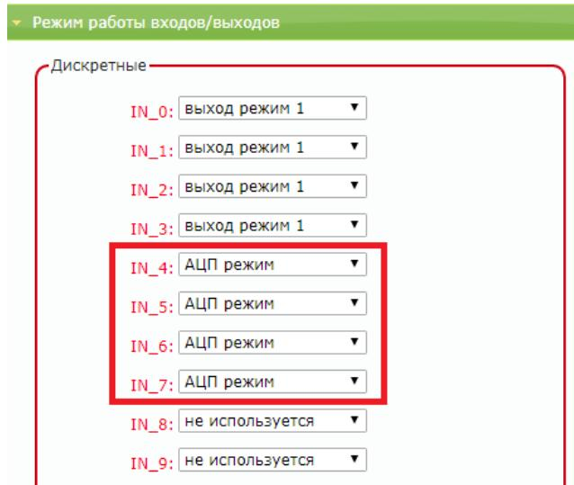
**Режим «не используется»** - нет отработки события при срабатывании входа
